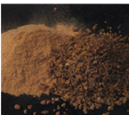
Tefor: het eerste plaatmateriaal verkregen door recycling van HPL productieafval.
